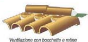
Ventilazione con bocchette e retine
